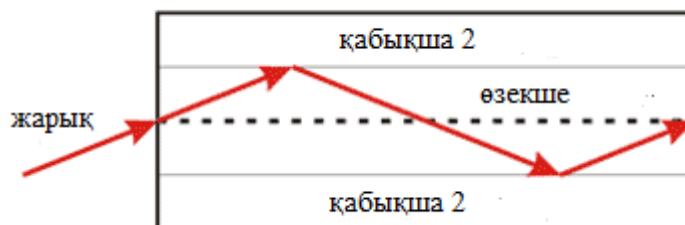
Сурет 2.10- Бірмодты талшықтағы модалық таралуы
